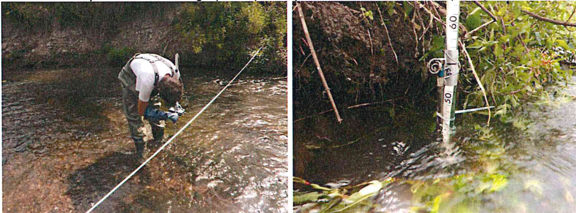
Figura 4-6: misura di portata nel mese di luglio (sinistra) con rispettiva lettura dell'asta metrata (destra)
